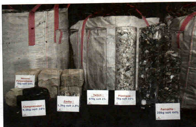
Ce qu'il reste d'un réfrigérateur après son traitement par Terecoval.
